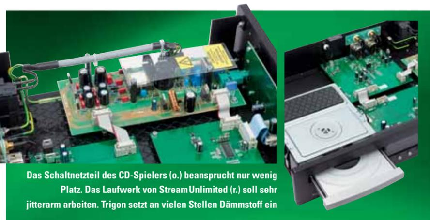
Das Schaltnetzteil des CD-Spielers (o.) beansprucht nur wenig Platz. Das Laufwerk von StreamUnlimited (r.) soll sehr jitterarm arbeiten. Trigon setzt an vielen Stellen Dämmstoff ein
